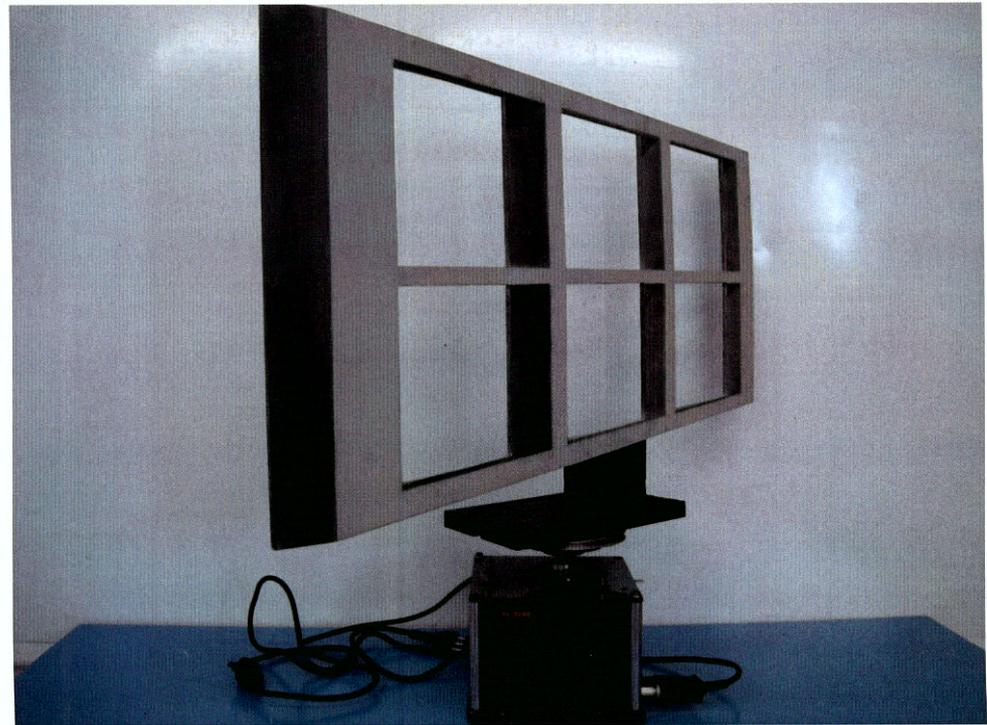
MOTORE CON SOVRAPPOSTA "FINESTRA ROTANTE" PER ESPERIMENTO SULLA PERCEZIONE VISIVA.
