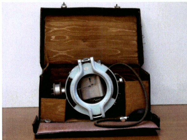
SFIGO-OSCILLOGRAFO "SEGRE" COMPLETO CON CAPSULA PNEUMOGRAFICA
